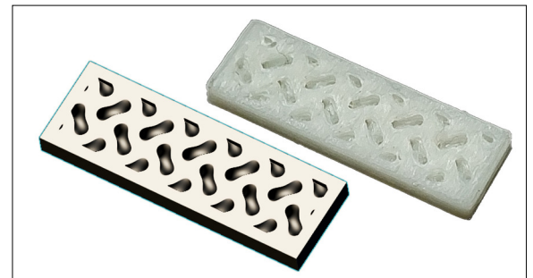
Abb.1 Struktur: Strukturtyp Gyroid, Grösse der Zelle 4mm, Wanddicke 0.8mm, 1.6mm Tiefe im nTopology und gedruckt Eigene Darstellung
