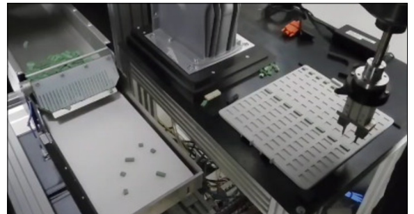
Einfluss von konstantem Lichtverhältnis auf Objekterkennung durch Abschirmung der Anlage. (oben: vorher, unten: nachher) Eigene Darstellung
