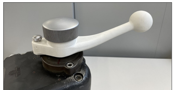
Abbildung 3: Im SLS-Verfahren, additiv gefertigter Bedienhebel, montiert in finaler Einbauposition am Führerbremsventil. Eigene Darstellung
