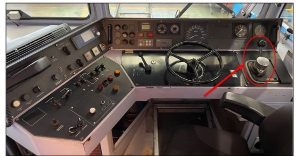
Abbildung 1: Führertisch im Steuerwagen BDt 1722 mit dem bestehenden Führerbremshebel. Eigene Darstellung
