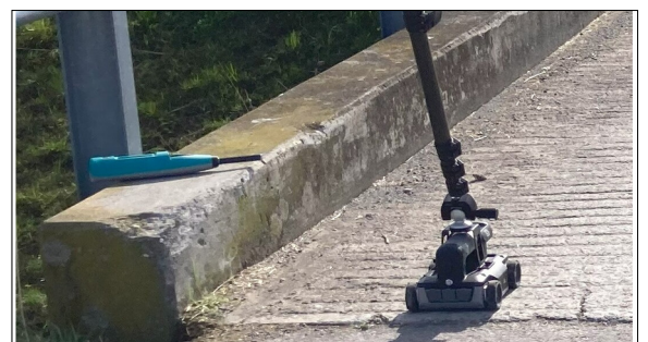
Georadar und Rückprallhammer Eigene Darstellung
