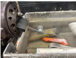
b) Strang nach Düsenaustritt (ca. 160 °C) beim Eintritt ins 90 °C Wasserbad
