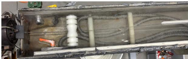
c) Wasserbadkühlung mit definierter Strangführung, Zieltemperatur nach 0.5 m: ca. 140 °C.
