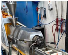
a) Extruder mit 3 mm-Düse bei 260 °C Schmelztemperatur
