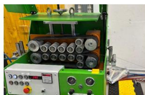
f) Abzugsmaschine zur Stabilisierung der Stranggeschwindigkeit (28 m/min)
