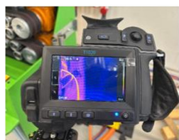
g) Wärmebildaufnahme des Strangs nach der Abzugseinheit (ca. 96 °C)
