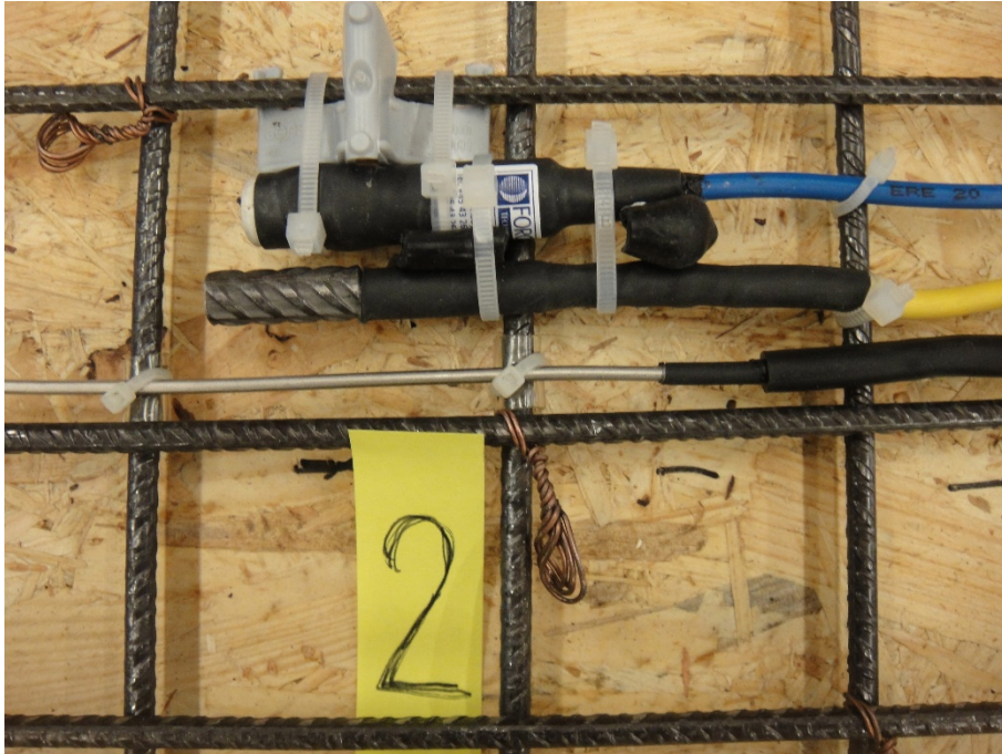
Bild 8: Überwachungssensoren (von oben nach unten: MnO 2 -Bezugs elektrode, Messcoupon, Potentialanstiegssensor)
